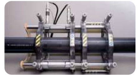
Broyer les pièces à souder et vérifier l'alignement
