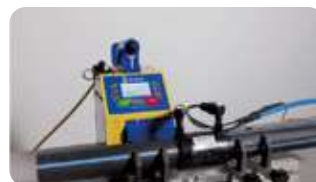
Mit der Schweißung beginnen. Die Kontrollen durchführen (Schweißparameter und Ausrichtung).
