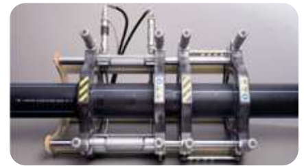
Fräsen der Elemente und Ausrichtung kontrollieren.
