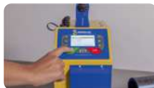
Mit der Schweißung beginnen. Die Kontrollen durchführen (Schweißparameter und Ausrichtung).
