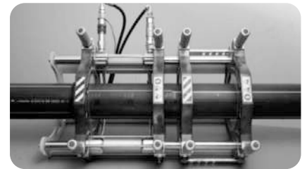
Fresare le parti da saldare e verificarne l'allineamento
